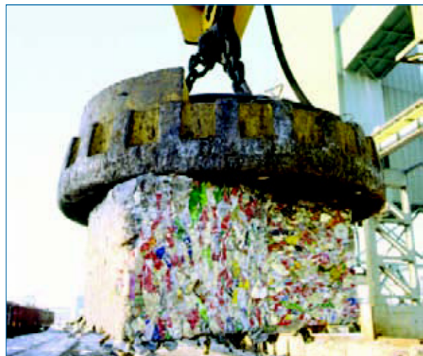
Les qualités magnétiques d'acier en permettent l'extraction facile dans un flux de déchets.
